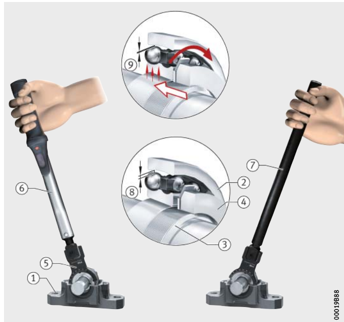
Figure 4 Réduction du jeu radial
