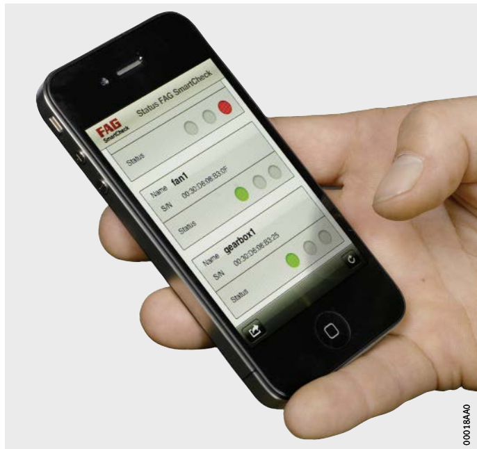
Figure 2 Smartphone comme récepteur d'alarme
